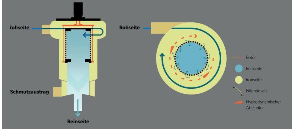
Funktionsprinzip des Zyklonfilters.
